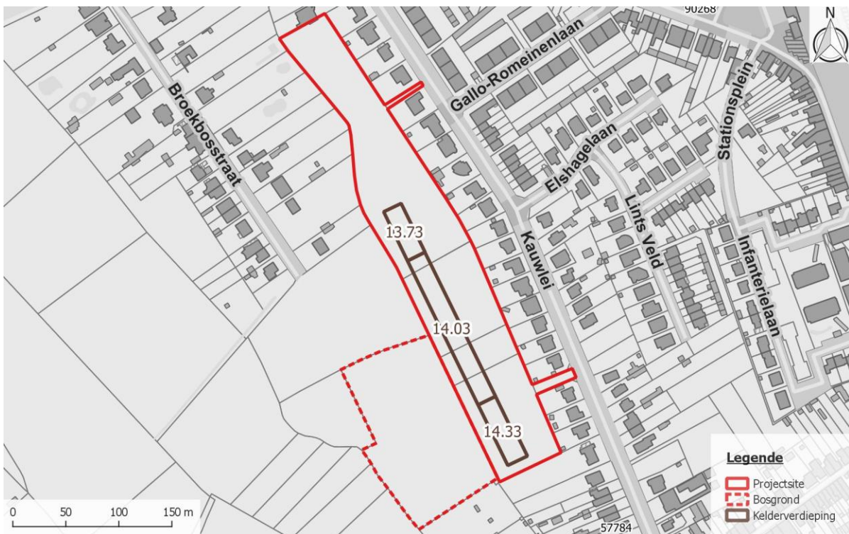
Figuur 12: Locatie van de bouwput voor de ondergrondse verdieping met de uitgravingspeilen.
