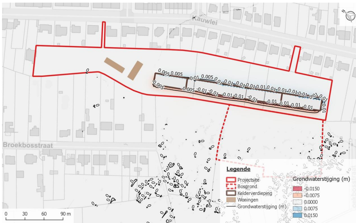
Figuur 35: Grondwaterstijging (m) onder invloed van de permanente situatie bij een 1,0 meter hogere grondwaterstand.
