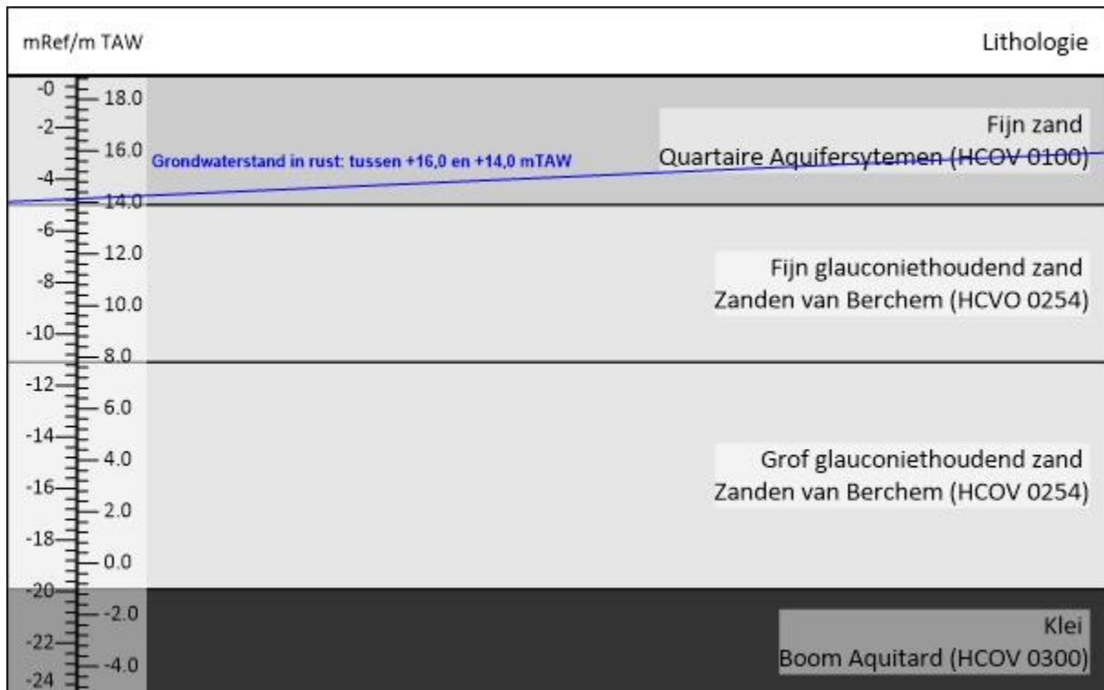
Figuur 10: Vereenvoudigd hydrogeologisch profiel ter hoogte van de projectsite.
